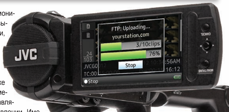
Отображение на дисплее камеры процесса передачи материала по FTP
